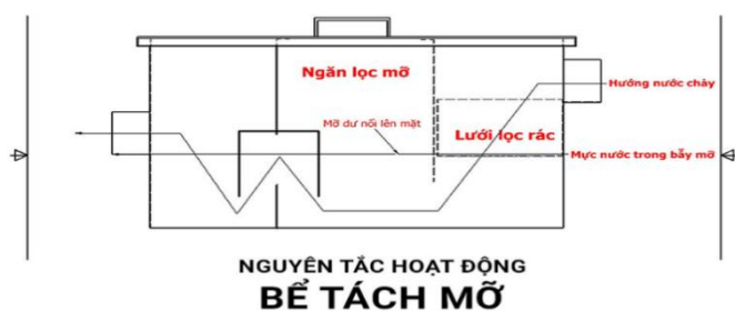
Hình 4.2. Nguyên tắc hoạt động và cấu tạo của bể tách dầu mỡ
